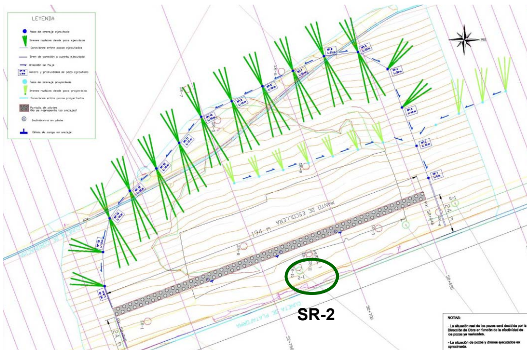
Estabilización de taludes mediante pilotes
